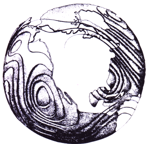
Рис. 14. Отклонение фигуры Земли от симметричного эллипсоида: а — объемное (пространственное) представление земного шара (масштаб отклонений сильно увеличен); б — разрез по меридиану; в — разрез по экватору. На рис. б и в: сплошная линия — геоид, пунктирная — эллипсоид; отклонения даны в метрах
