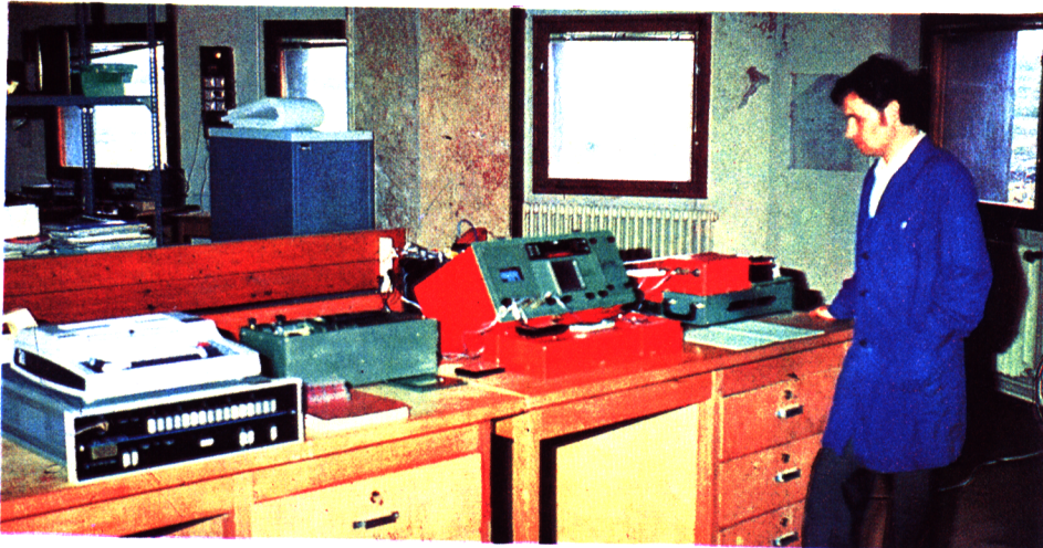
Рис. 8. Американский доплеровский приемник JMR-1 (станция Пенц), с помощью которого на основе наблюдений ИСЗ, имеющих доплеровские передатчики, можно определить координаты наземной станции (точность — порядка 1 м)
